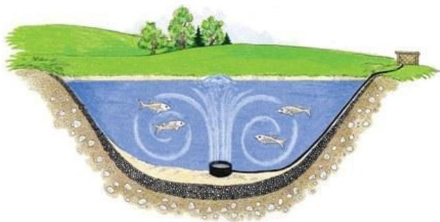
O sistema de aeração não deixa acumular o lodo no fundo mantendo-o sob agitação oxidando-o rapidamente pelo oxigênio dissolvido. Todo o perfil de água passa a ser oxigenado aumentando o volume útil de criação para os peixes. Também evita as condições ácidas de fundo e morte de peixes associada com inversões térmicas do lago ou inversões de camadas da água.
